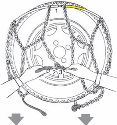
**CK** Uchopte řetěz a jemnými vibracemi jej potáhněte směrem dolů; otevřete lanko (1), nechte spadnout řetěz na zem a otevřete háček (2 - 3).
